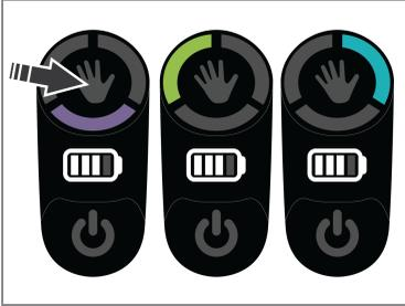
Für die Navigation durch die drei verfügbaren Profile drücken und halten Sie das Hand-Symbol am Kontroll-Pad gedrückt.
