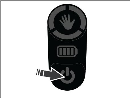
Zum Einschalten der Carbonhand drücken Sie die Ein/Aus-Taste. Warten Sie, bis die Profilanzeige nicht mehr blinkt.
